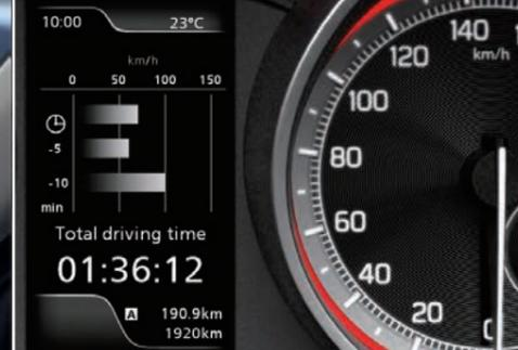
Au centre des deux compteurs principaux, un écran couleur LCD de 4.2 pouces affiche différentes informations relatives à la conduite avec des graphiques simples à appréhender comme : l'enregistrement des temps de conduite, mesure des accélérations et du freinage exercés, indication du couple et de la puissance en temps réel.
