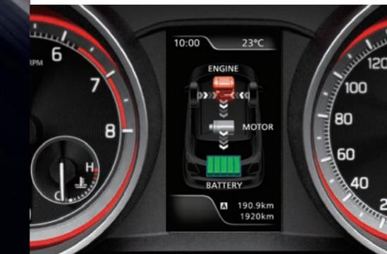
Développé par Suzuki au Japon, ce dispositif est constitué d'un alternateur-démarrateur (alternateur + moteur électrique alimentés par une batterie autonome lithium-ion) qui vient assister le moteur thermique dans ses phases de fonctionnement les plus énergivores, au démarrage ou à l'accélération. Son fonctionnement permet d'abaisser la consommation de carburant de près d'un litre/100 km en cycle urbain, et adoucit considérablement la conduite.
